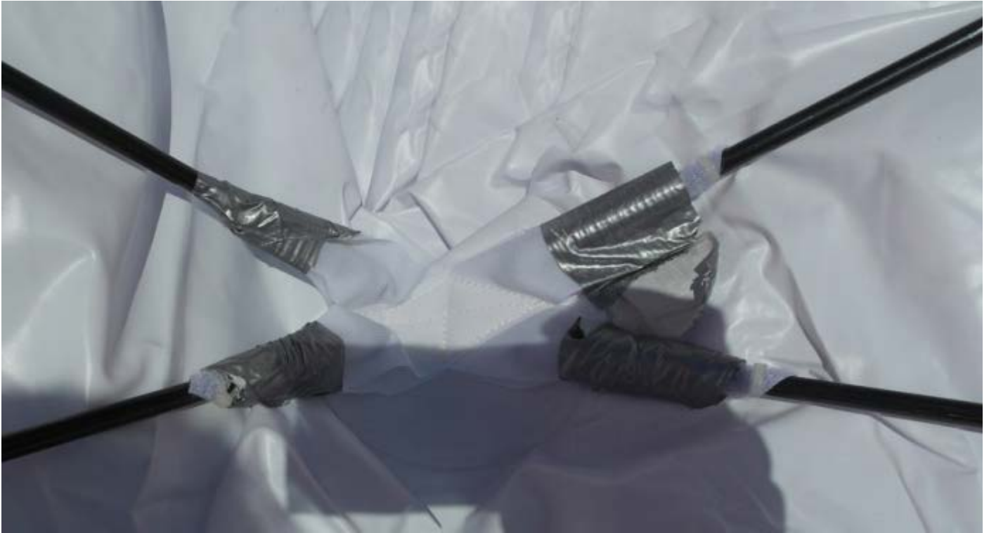
Fixation des 16 tiges des ailerons à l'aide du velcro et d'adhésif (entoilé de préférence)
