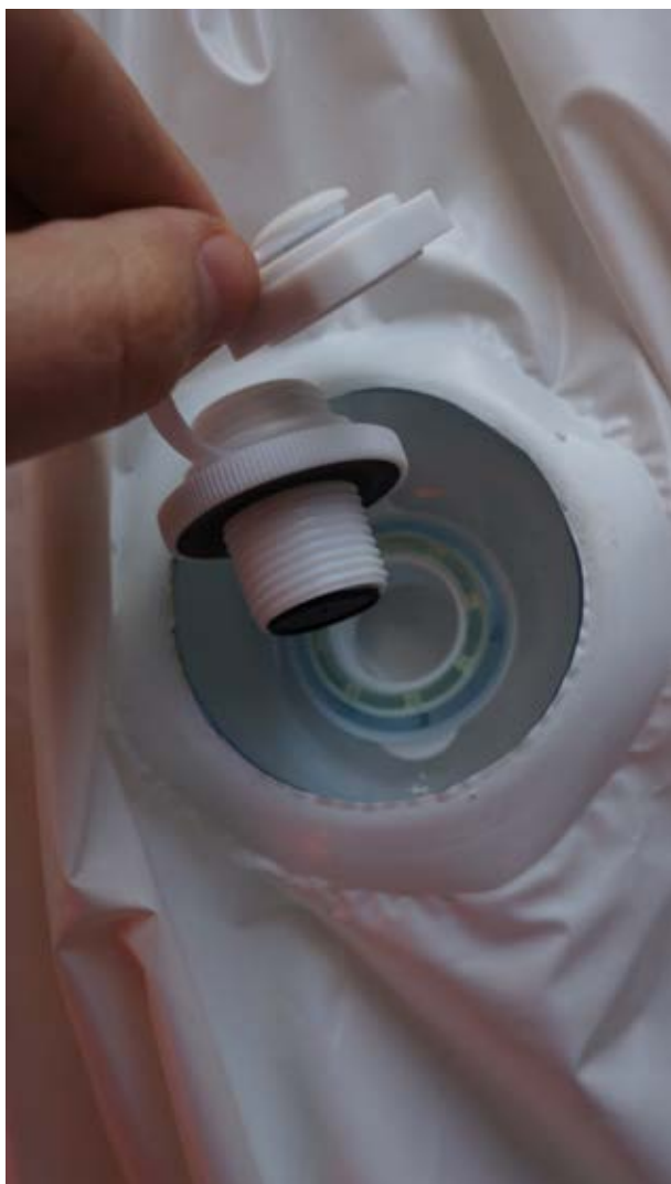
Valve dévissée pour gonflage
